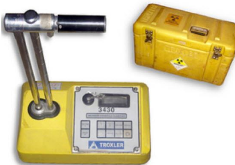
شکل ۳: دزیتر هسته‌ای با اجزای رادیواکتیو مثل آمرسیوم ۲۴۱، برلیوم و سزیم
